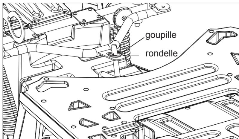
4. Assemblage du moteur Retirez les rondelles et les contre-écrous de l'essieu avant, insérez le moteur dans l'essieu avant, connectez les deux fiches du moteur et de la carrosserie.
