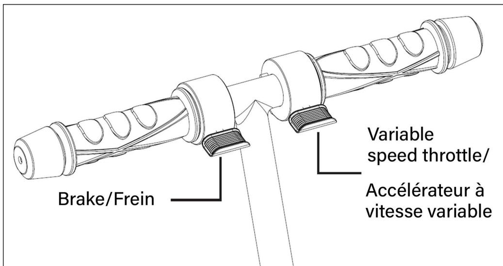
Il y a un interrupteur de vitesse variable sur le guidon, la vitesse est contrôlée par cet interrupteur, plus vous appuyez fort, plus la voiture sera rapide, relâchez l'interrupteur, la voiture s'arrêtera.
