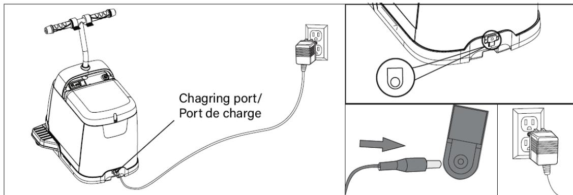
1. Tout d'abord, insérez le chargeur dans le port de charge.
