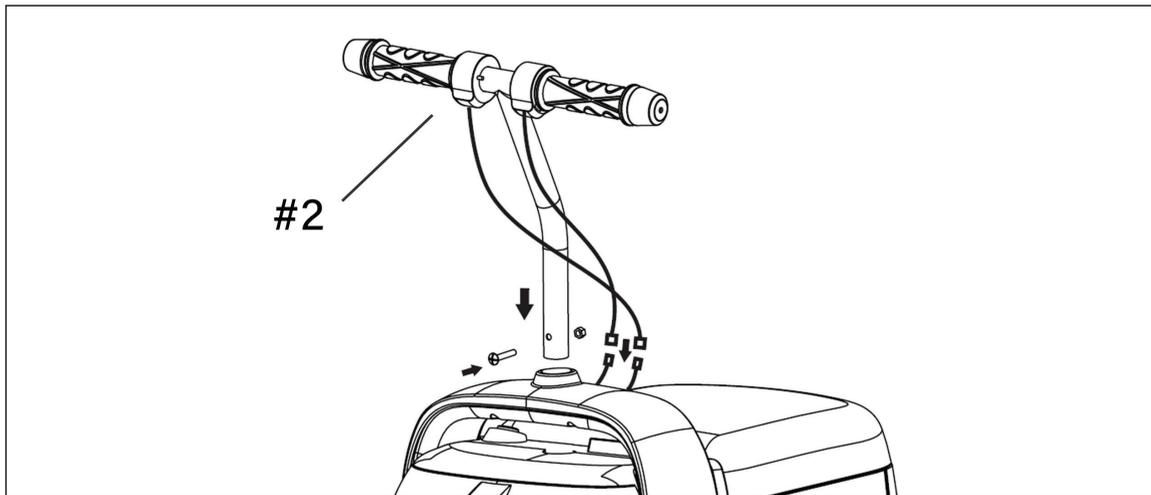
Connectez les câbles de couleur correspondante. Faites glisser autant de câbles que possible dans l'ouverture, puis placez le couvercle et fixez-le avec 2 x vis.
