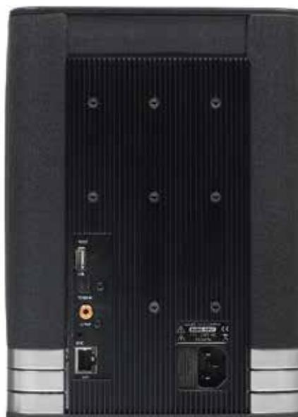
*Rechts die Rückseite der Tana L-1. Links die Tana SL-1. Die Verbindung der beiden Boxen geschieht drahtlos über eine Funkstrecke mit 96 kHz bei 24 Bit*
