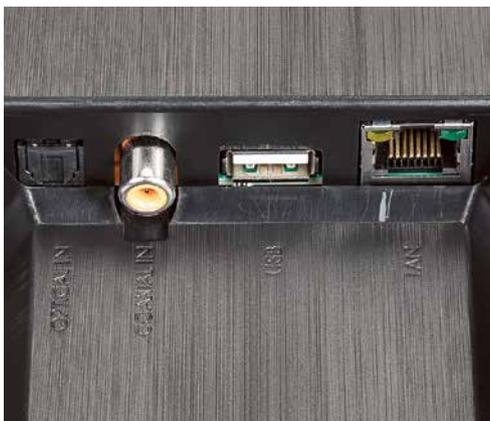
**Hinein geht es bei der Tana SL-2 ausschließlich digital via LAN, koaxial, optisch oder mittels eines USB-Speichers (Stick/HDD).**
