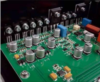
Die Leistungsverstärkung erfolgt in klassischer AB-Technik – die entsprechenden Transistoren sitzen in Reih und Glied auf dem Kühlkörper
