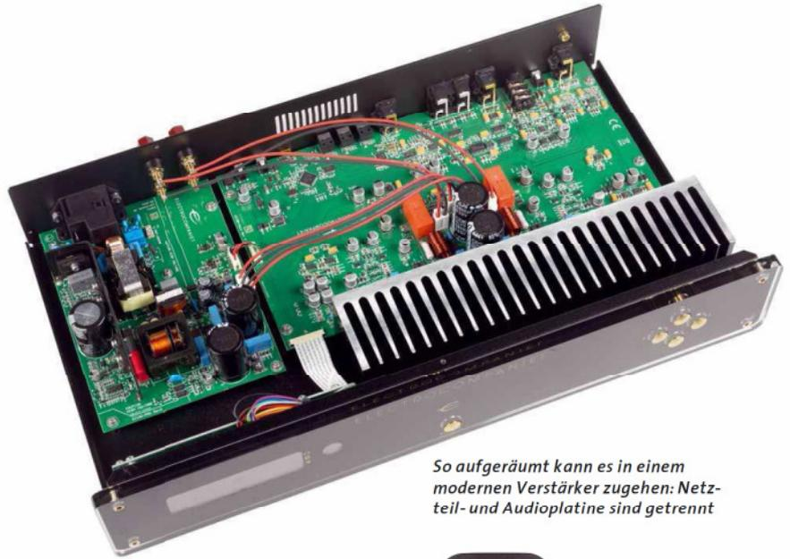
So aufgeräumt kann es in einem modernen Verstärker zugehen: Netzteil- und Audioplatine sind getrennt
