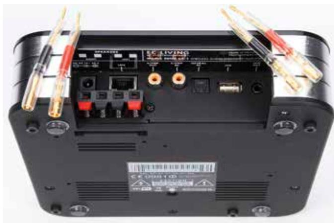
Aus Platznot musste Electrocompaniet beim SA-1 auf große Lautsprecherterminals verzichten. Immerhin liegen dem Vollverstärker Adapter für Bananakabel bei.
