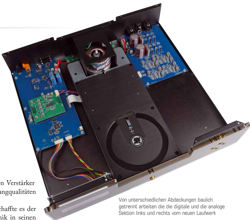
Die Wandlersektion in Grün kann bei Nutzung der digitalen Ausgänge auch umgangen werden, wobei man aber auf das Upsampling verzichten muss
