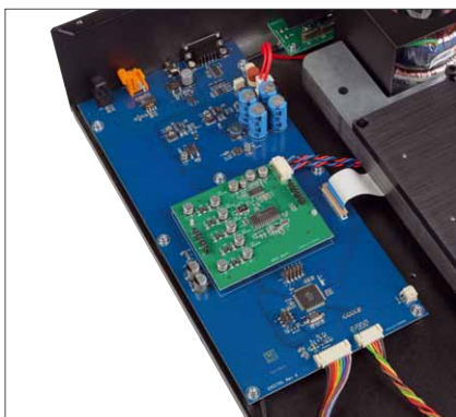
Die Wandlersektion in Grün kann bei Nutzung der digitalen Ausgänge auch umgangen werden, wobei man aber auf das Upsampling verzichten muss
