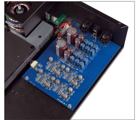
Das analoge Ausgangsboard ist vollständig symmetrisch aufgebaut
