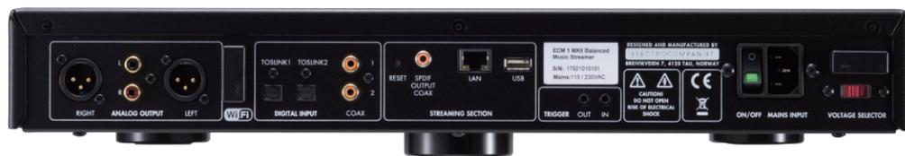
本機のリア部。入力は同軸とTOSが各2系統、ストリーミング・セクションとしてLANと同軸、USB-A入力を装備する。外部ドライブは底板にネジ止めされたパネルを外して組み込めるようになっている
