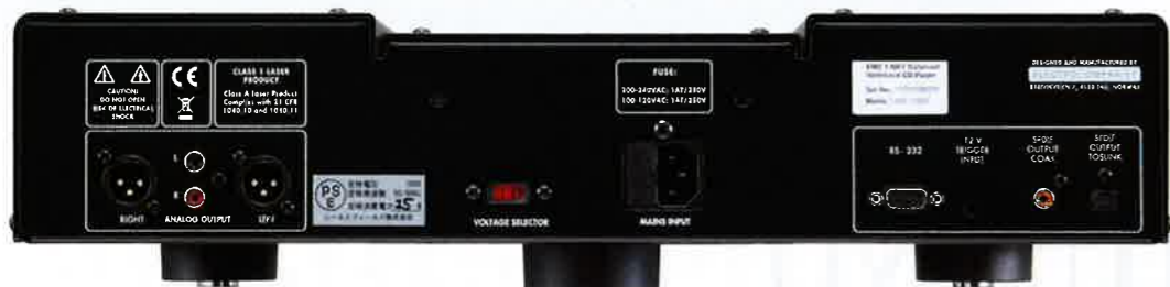
本機のリア部。アナログ出力はRCAとXLRが各1系統ずつ。その他にRCA同軸と光TOSのデジタル出力を装備
