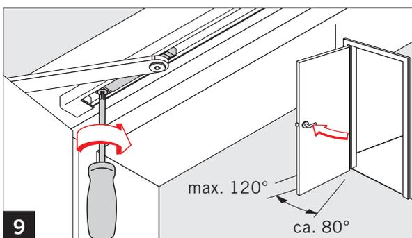
**!** Durch den Einsatz der Öffnungsbegrenzung soll verhindert werden, daß eine **normal** geöffnete Tür gegen angrenzende Wände stößt. Sie ist keine Überlastsicherung und ersetzt in vielen Anwendungsfällen nicht einen Türstopper. Öffnungsbegrenzung einstellbar zwischen 80° und max. 120°
