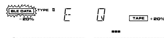
Lorsque l'accord AUTO BLE est terminé, la position standard de l'échelle de polarisation (les segments ouverts) se déplacent sur la même position que la position de réglage supérieur.
