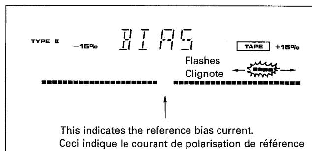
Lorsque la touche + ou - BIAS est enfoncée, les vumètres des canaux gauche et droit changent automatiquement du mode de polarisation au mode précédent, après environ 4 secondes.
