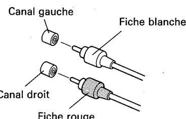
Raccorder les prises TAPE de l'amplificateur aux prises LINE de la platine cassette. Toujours raccorder les prises REC (INPUT) de la platine aux prises d'enregistrement (sortie) de l'amplificateur et les prises PLAY (OUTPUT) de la platine aux prises PLAY (INPUT) de l'amplificateur.
