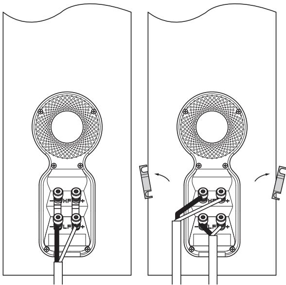
所有的连接应当在设备关闭时进行。
