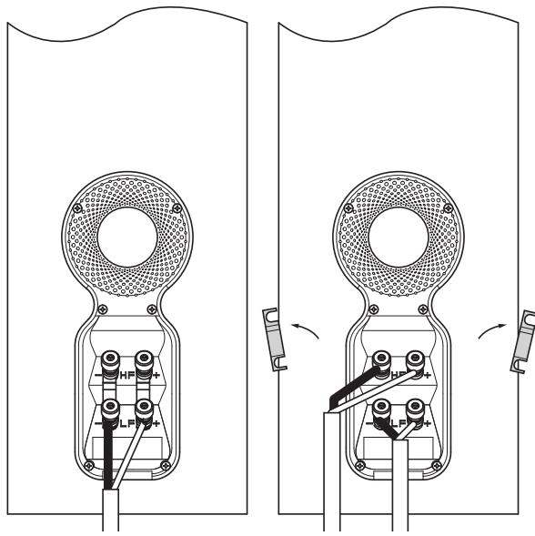
Todas las conexiones deberían realizarse con el equipo desconectado.
