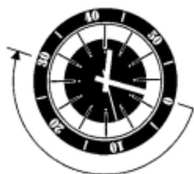
Si su reloj está equipado con un aro exterior móvil en incrementos de un minuto, esta pieza puede ser usada de varias maneras para saber el tiempo transcurrido. Por ejemplo, si un buzo tiene 30 minutos de aire, puede colocar el aro exterior de forma que el triángulo esté en línea con el minuterero cuando se sumerja. El minuterero le indicará en el aro exterior el tiempo que el buzo ha estado sumergido.
