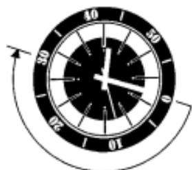
Si votre montre est équipée d'un cadran extérieur (ou anneau) rotatif avec traits d'une minute, ce cadran peut être utilisé de diverses façons pour vérifier le temps écoulé. Par exemple, un plongeur ayant une alimentation en air de 30 minutes peut régler l'anneau extérieur pour que le triangle soit vis-à-vis l'aiguille des minutes au moment où il plonge.
