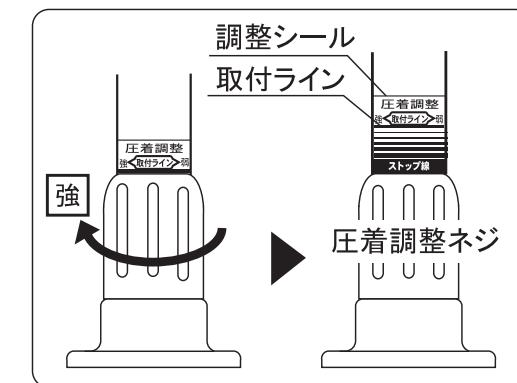
※ 圧着調整は、調整シールの「ストップ線」までにしてください。
