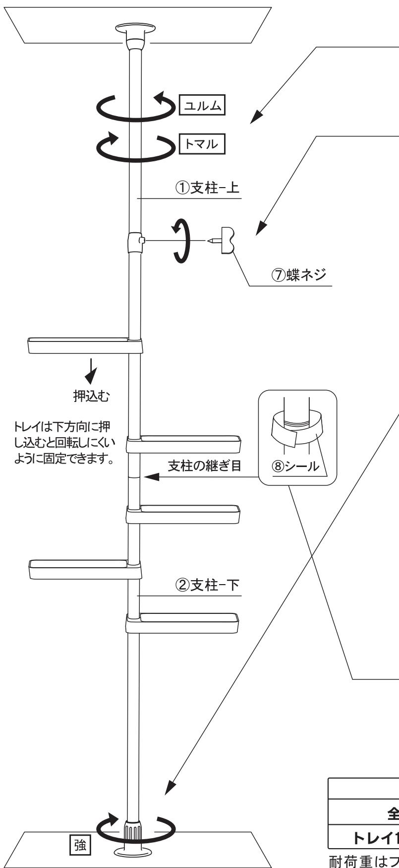
① ①支柱・上 の「細いパイプ」を「ユルム」の方向に回してから、天井までいっぱいに伸ばし、次に「トマル」の方向に回して、しっかりと固定します。
