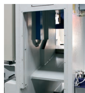
Retro pressa con scivolo per scarico sfridi Machine back side with chute for scraps discharge
