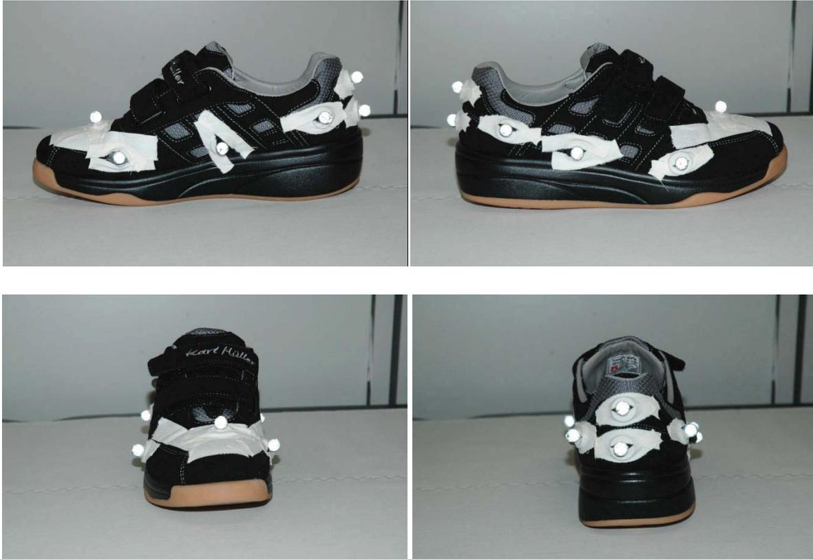
**Abbildung 2: Typische Markerpositionierung auf den Schuhen.**
