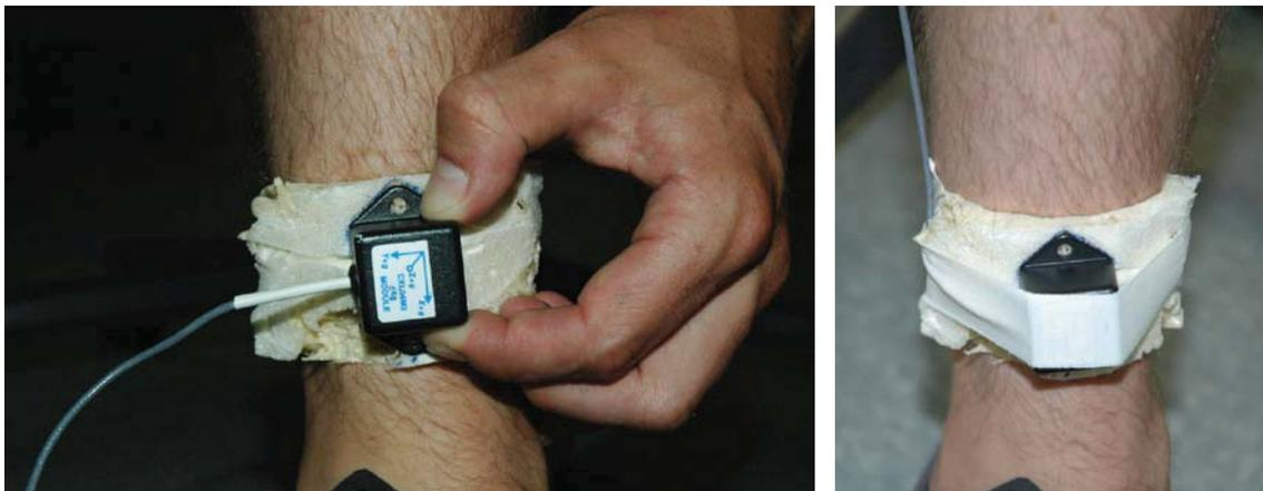
**Abbildung 3: Befestigung des Beschleunigungssensors an der Tibia.**
