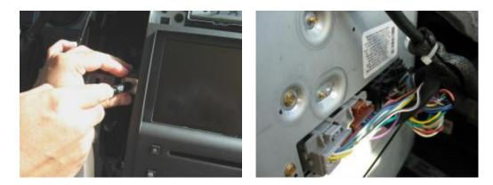
4. INSTALL THE SUPPLIED GPS ANTENNA JUST BENEATH YOUR WINDSHILED DASH COVER (UNDER THE WINDSHIELD). PRY UP PANEL TO GAIN ACCESS. ROUTE THE GPS ANTENNA CORD TO THE REAR OF THE NAVIGATION RADIO AND PLUG INTO THE BLUE FAKRA CONNECTOR.
