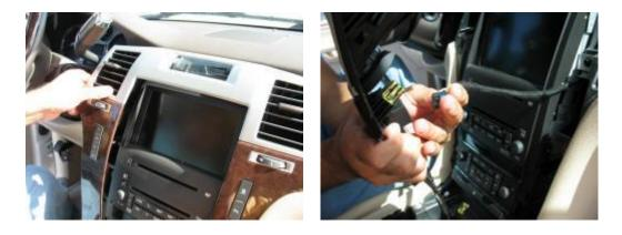
3. FINISH BY REMOVING THE SCREWS AROUND THE OUTSIDE OF THE SCREEN/RADIO AND TILTING THE ASSEMBLY REARWARD TO VIEW THE CONNECTORS. UNPLUG THE CONNECTORS.
