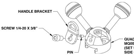
QUAD BALL ADAPTOR MQ000100 (SET UP FOR RIGHT HAND SIDE OF HOUSING)
