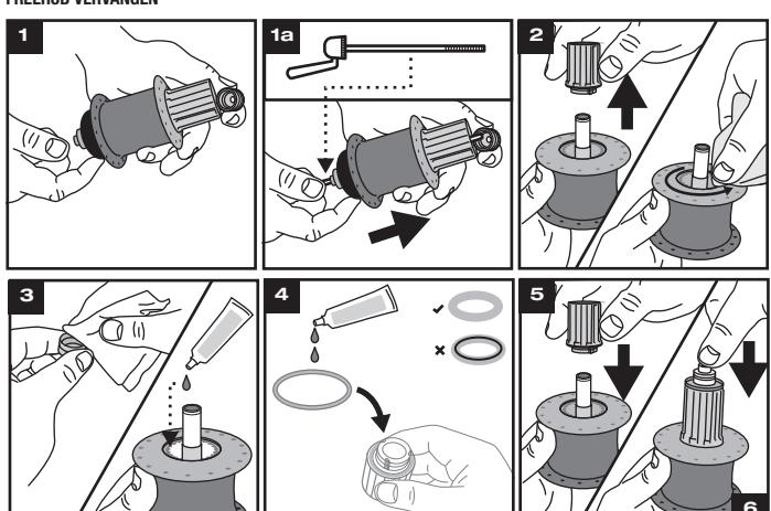
1. Verwijder het deksel aan de kant van het vrijwiel met een korte ruk. Het is mogelijk dat u een asschroef nodig hebt om het deksel vast te houden tijdens de demontage. Als het deksel vastzit, maak dan gebruik van een snelle-ontgrendelingspin om het deksel los te duwen van aan de andere kant.
