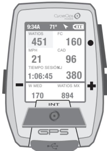
Joule GPS es compatible con cualquier medidor de potencia, sensor de velocidad, sensor de cadencia o sensor de frecuencia cardíaca compatible con ANT+.
