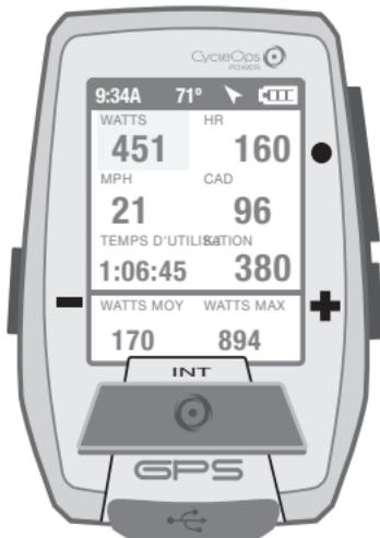
Le GPS Joule fonctionne avec les wattmètres, capteurs de vitesse, capteurs de cadence et capteurs de fréquence cardiaque compatibles ANT+.
