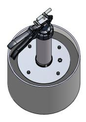
PLACE END OF GUN BARREL OVER FOLLOWER PLATE LIP. DEPRESS THE RELEASE PLATE AND DRAW BACK THE ROD, IN TURN DRAWING UP THE MATERIAL INTO THE BARREL. ENSURE THE BARREL STAYS FLUSH TO THE PLATE
