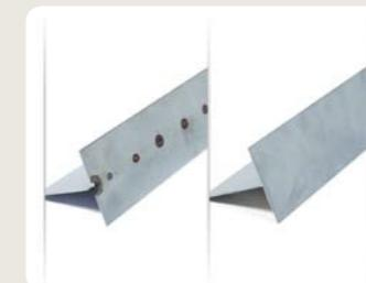
На рисунке отчетливо показано различие сварных точек. Функция MicroTack применялась при сварке заготовки справа. Для прихватки заготовки слева применялась обычная сварка TIG.
