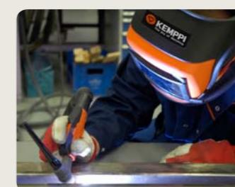
Функция MIX TIG – это сочетание лучших свойств сварки на переменном и постоянном токе. Она облегчает сварку алюминия и уменьшает деформацию.
